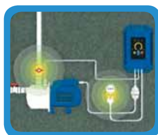
7. stiskněte start, vyčkejte než se přístroj načte, znovu otevřete přívod vody a systém bude pracovat při konstantním tlaku
